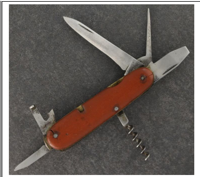
Arriba: variante inicial con 6 herramientas en 3 capas
