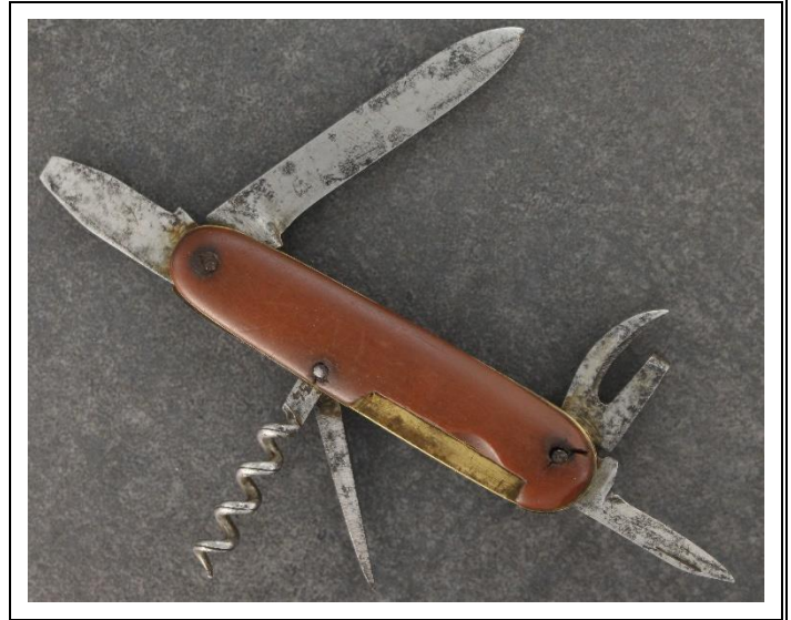
Arriba: variante posterior, las mismas 6 herramientas en 2 capas
