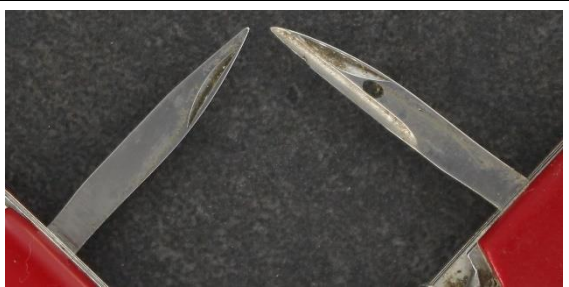
Los punzones de las dos navajas son completamente diferentes. El punzón de Henckels de la izquierda es muy sencillo y no tiene funciones avanzadas.
