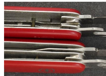
En cuanto al ojal del llavero, existen grandes diferencias. Cuando se trata de revestimientos en general, existen grandes diferencias (imagen arriba a la derecha). Mientras que los forros de Victorinox (navaja inferior) son parcialmente continuos, en Henckels están en gran medida recortados.
