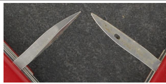
Los punzones de las dos navajas son completamente diferentes. El punzón de Henckels de la izquierda es muy sencillo y no tiene funciones avanzadas.
