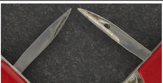
Les poinçons des deux couteaux de poche sont complètement différents. Le poinçon de Henckels à gauche est très simple, sans aucune fonction avancée.
