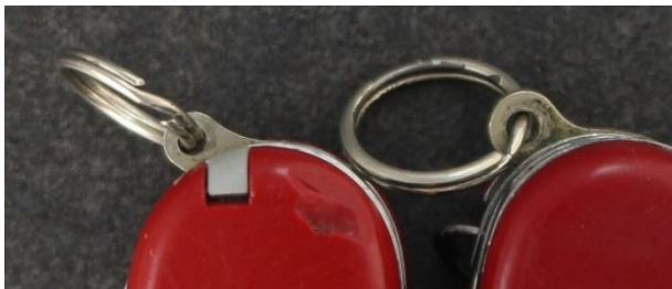
Il existe de grandes différences en ce qui concerne l'œillet du porte-clés. En ce qui concerne les doublures en général, il existe de grandes différences (photo en haut à droite). Alors que les doublures du Victorinox (couteau de poche inférieur) sont partiellement continues, chez Henckels elles sont en grande partie découpées.
